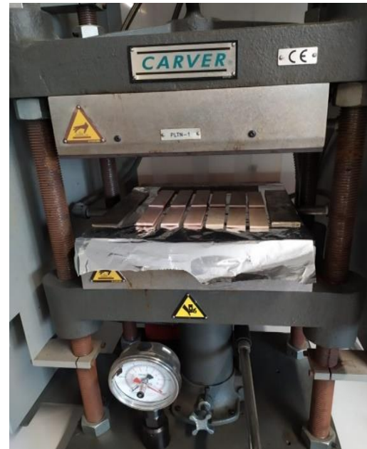
Şekil 2. Lap Shear örneklerini presleme işlemi
